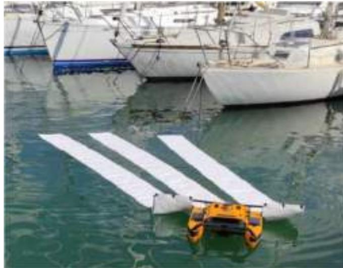
**Imagen 7.** Equipo Jellyfishbot juntamente de barreras absorbentes
