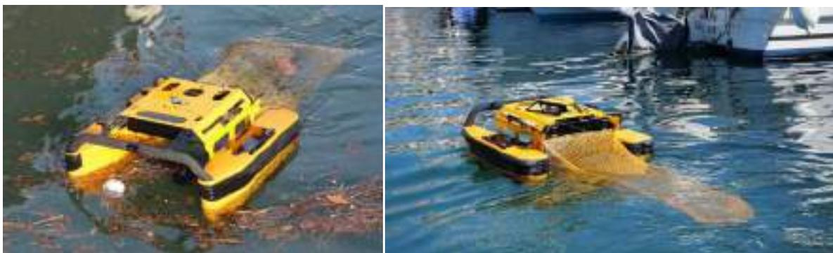
**Imagen 8.** Equipo Jellyfishbot recogida de residuos en suspensión
