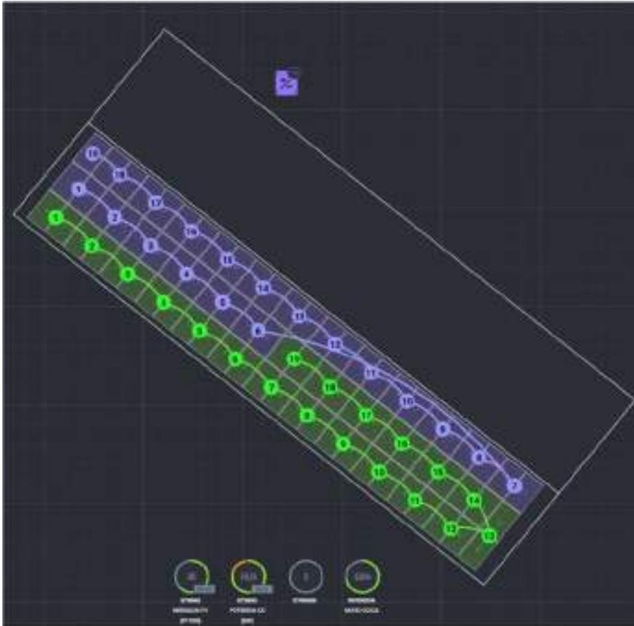
Ilustración 8: Configuración de los strings
